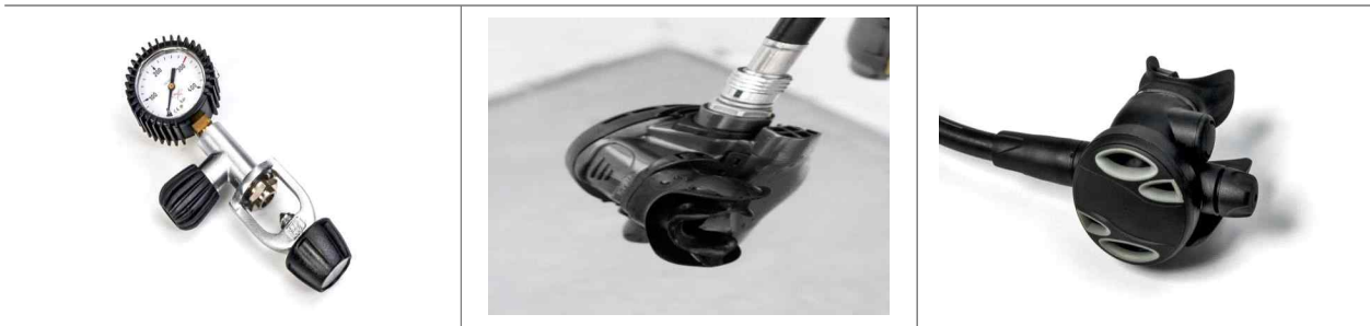
1단계 호흡기 2단계 주 호흡기 보조 호흡기 탱크의 고압 공기를 다이버에게 호흡할 수 있도록 압력을 낮추어서 공급하는 기계 장치이며, 1단계 호흡기를 거쳐 2단계를 통해 공기압력을 낮춰 다이버가 호흡할 수 있도록 함 (1단계 호흡기에 보조 호흡기 및 계측기를 부착함)
