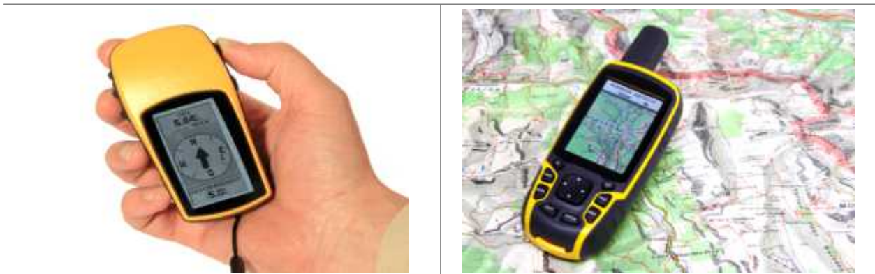
세계공용 457khz 주파수 사용하여 눈사태에 매몰되거나 실종된 사람을 찾아내는 장비로 DVA, ARVA, 비콘 등으로 불림
