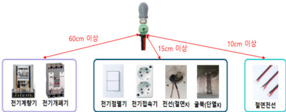
전기설비와의 이격거리 측정 예시(호스이음부의 경우)
